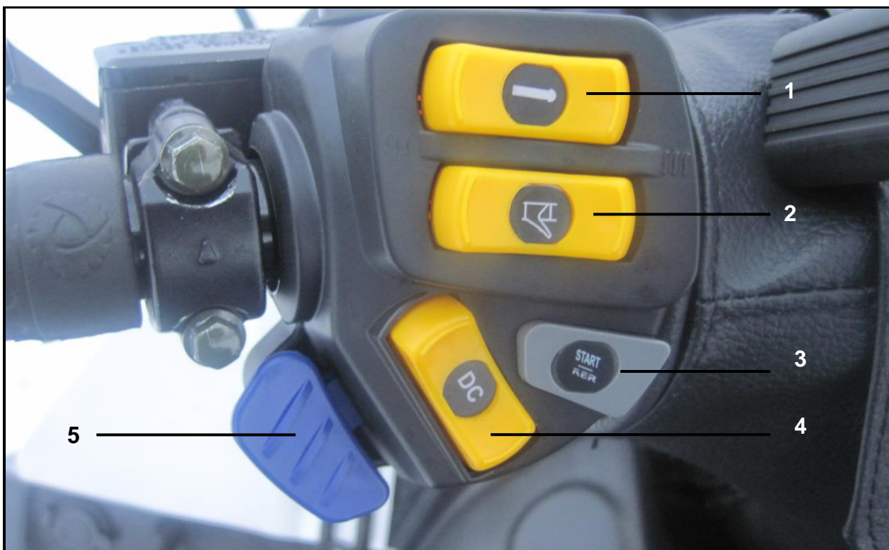
Рисунок 4в - Расположение органов управления на левом блоке руля снегохода TAYGA Patrol 800 SWT
