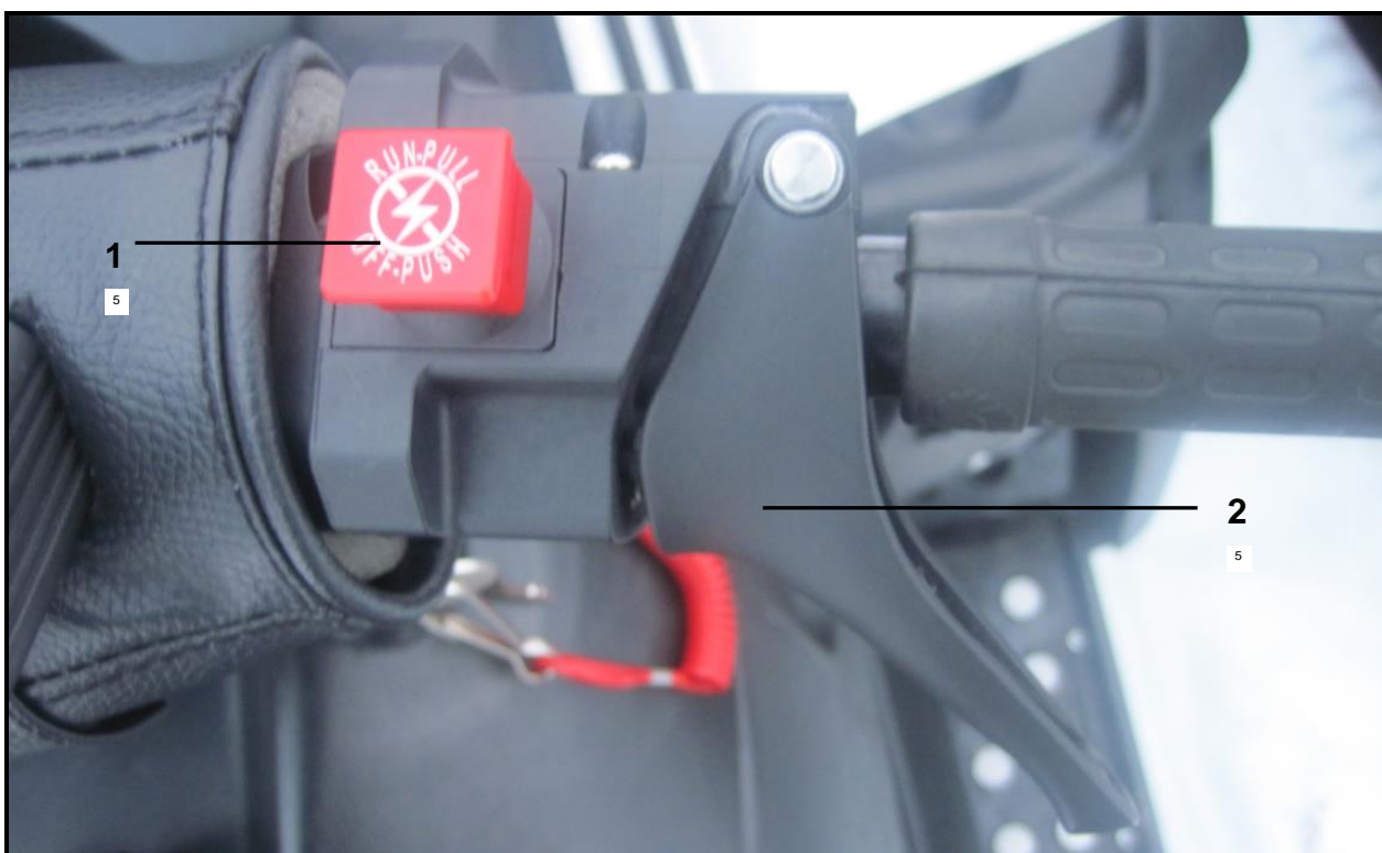
Рисунок 4г - Расположение органов управления на правом блоке руля снегохода TAYGA Patrol 800 SWT
